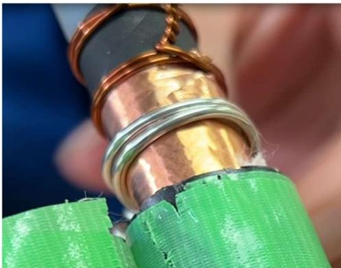
図5-1 すずめっき線取り付け
