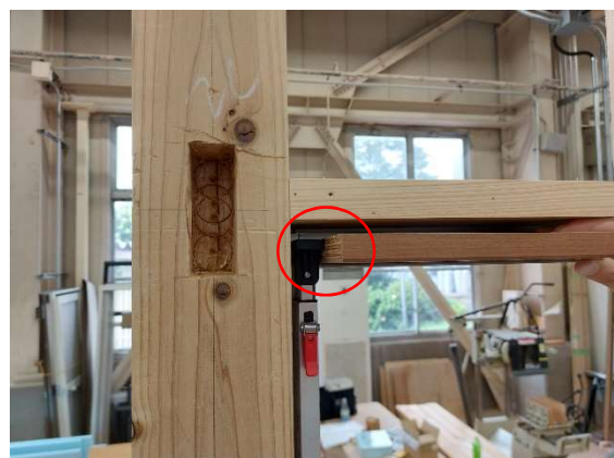
写真 14-3 枠材の厚み 21mm
