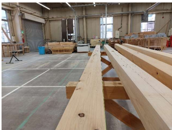
写真 3-3 水糸による材料の反り確認
