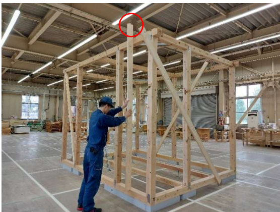
写真 9-3 短ほぞを上にした状態で高さを計測
