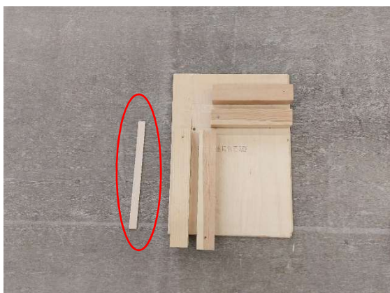
写真 14-5 枠材固定用治具 (左: 3mm ベニヤ)
