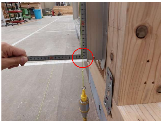
写真 11-47 サッシと下げ振りの距離 13mm
