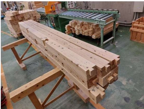
写真 5-1 旧梁材、旧土台
