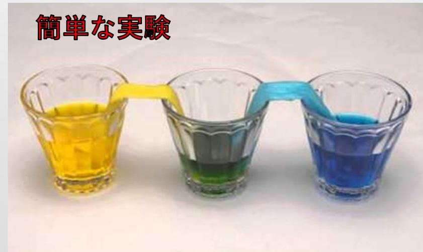
「毛細管現象」で、はんだが狭い隙間に入る！
