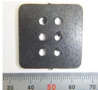
図 3 溶融した切りくずの付着
