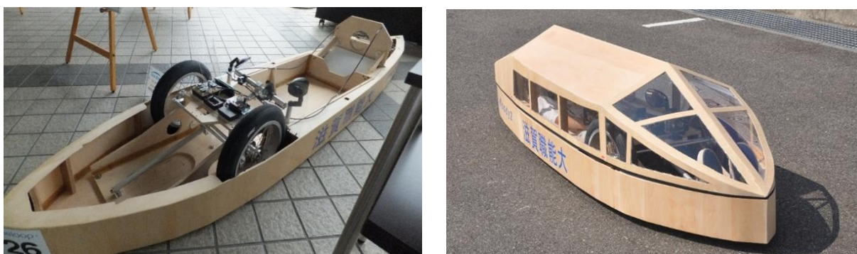
図4 木製フレームに変更した2018年の車体
