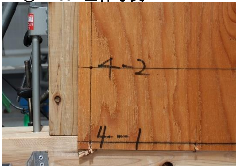
②釘のパンチング状況
