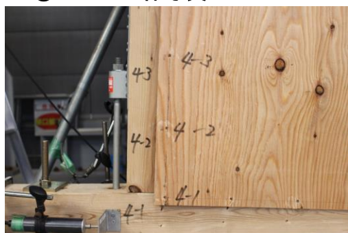
② 釘のパンチング状況
