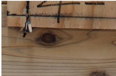
⑤K-300 面材の割裂破壊(引張側)
