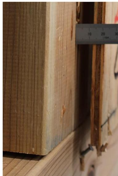
⑧K-600 面材の割裂破壊(引張側)
