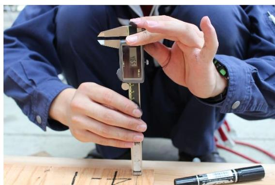
図 2.3 釘頭のめり込み量を測定する様子
