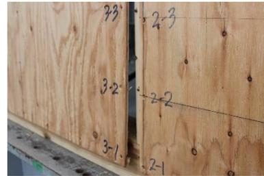
④ K-150-M 釘のパンチングシア(継手間柱)
