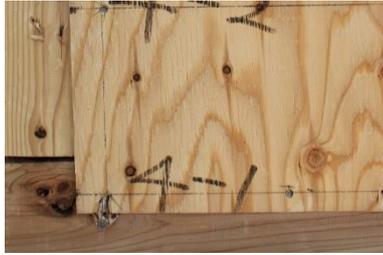
①K-150 面材の割裂破壊 (引張側)
