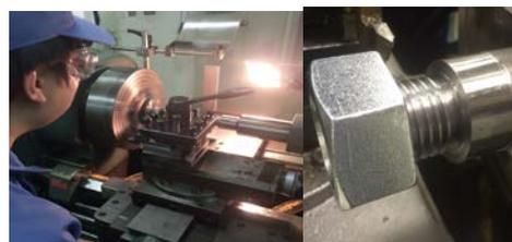
図3 車軸のねじり加工とねじ部
