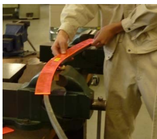
図4 曲線レール製作中
