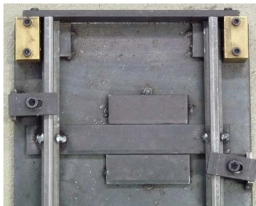
図2 溶接部と治具
