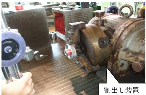
図 4. 割り出し装置での目盛付け
