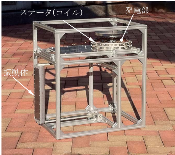
図 1. 振動発電装置の構造 (2 号機)
