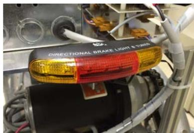
図 4 ウインカー&ブレーキランプ
