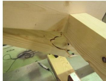
写真7 試験体1の破壊部分
