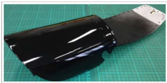
図17 塗装後のフェンダー
