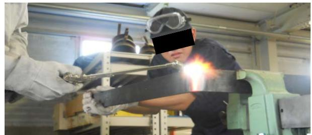
図2 ガス溶接吹管を用いた作業
