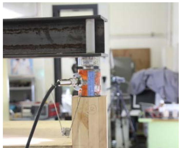
図 2-3-7 ロードセルの設置例
