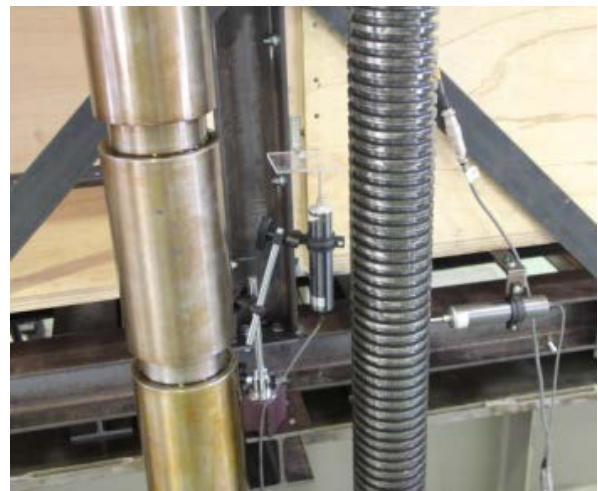
図 2-3-6 変位計設置例 変位計⑦(⑧)
