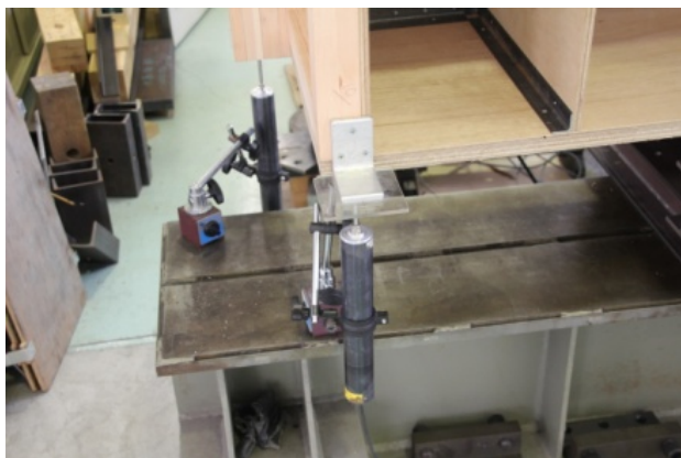
図 2-3-3 変位計設置例 変位計①,⑨(②,⑩)
