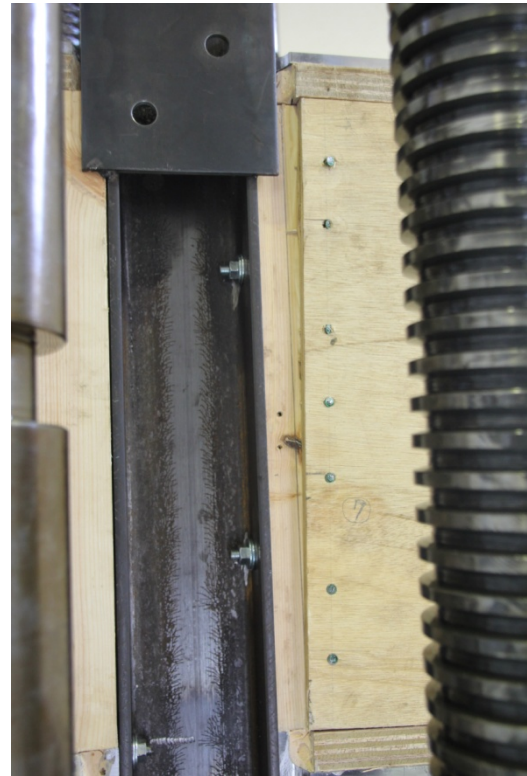
写真 6-5 破壊状況 背板の回転
