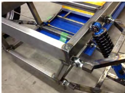
図9 メインフレームの半自動溶接
