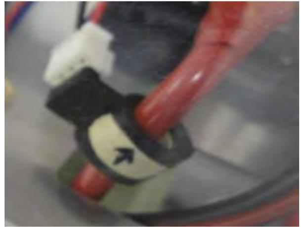
図 14 クランプメータ型消費電流計測 IC
