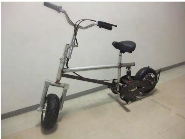
図3. 電動ポケットバイクの車体
