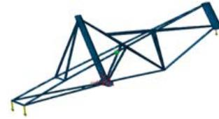
図 1 解析した自転車フレーム構造
