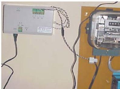
図 5. 消費電力量の計測
