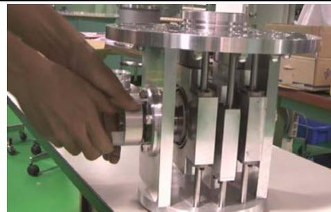
図4 製作したスコッチ・ヨーク機構
