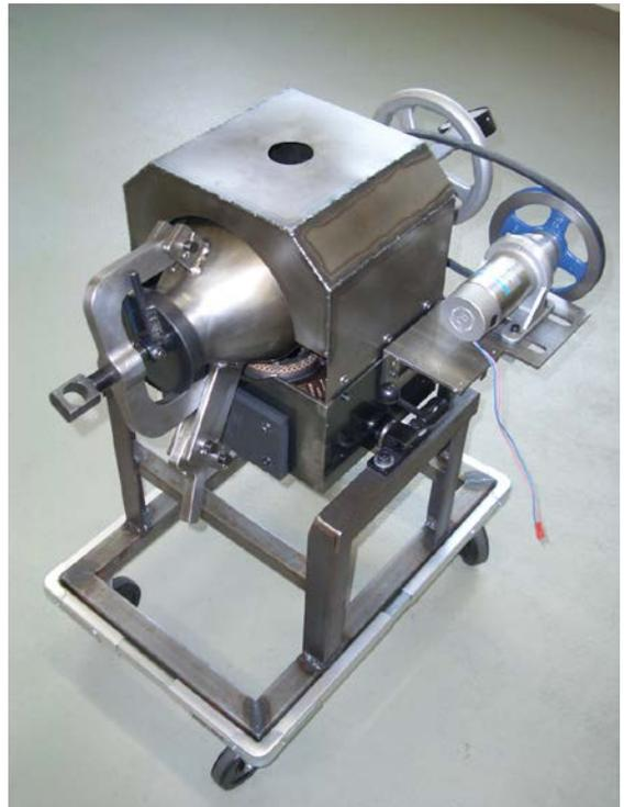
図1 完成したドン菓子製造機
