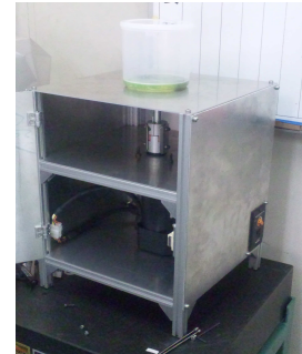
図 1 製作した磁気バレル研磨機
