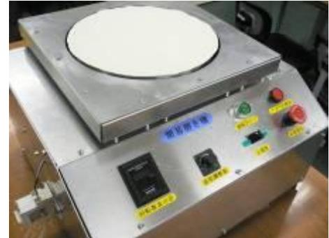
写真1 制作した簡易研磨機
