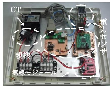
写真 1 分電盤に設置した親機
