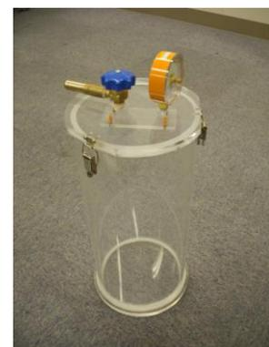
図1 製作した真空実験容器
