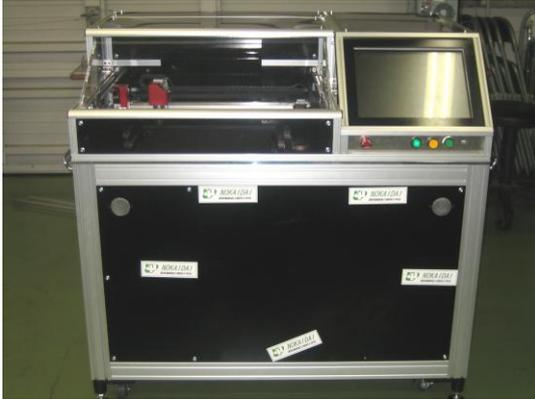
図1 レーザー彫刻機
