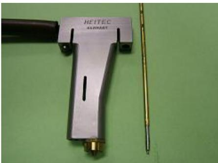
図 4 ホットランナノズル (バルブゲート)
