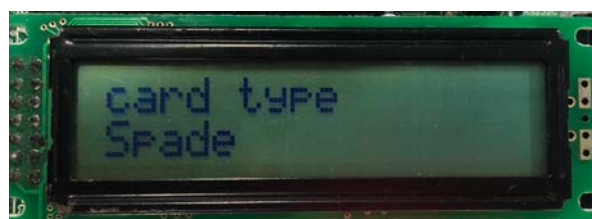
図3 LCDディスプレイの表示(♠の検出)
