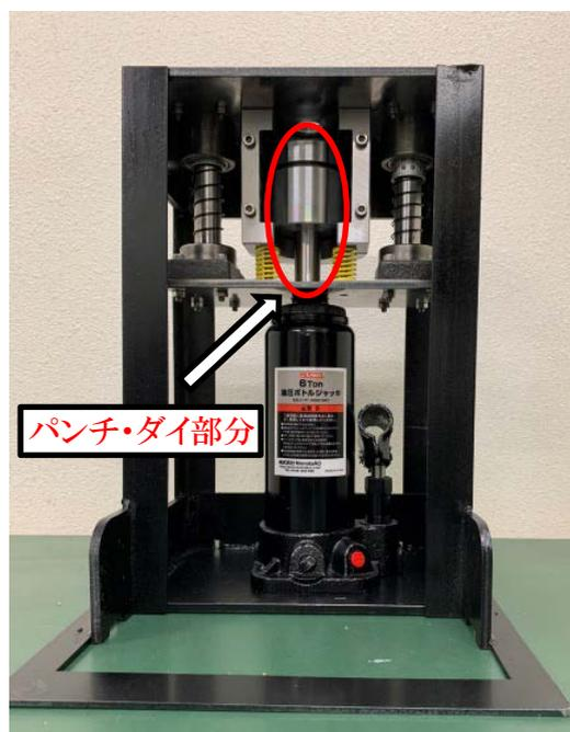
図3 コイン打ち抜き機
