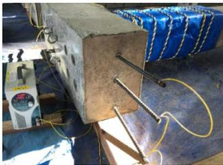
図2 電食状態の試験体
