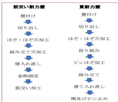
図1 筋交い・貫壁の施工手順
