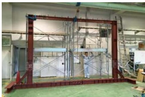
写真3 水平加力試験装置
