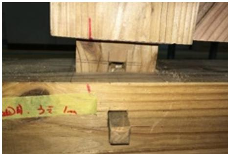
写真6 込栓の破壊の様子
