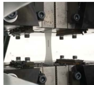
図1 アルミ材の引張試験の様子
