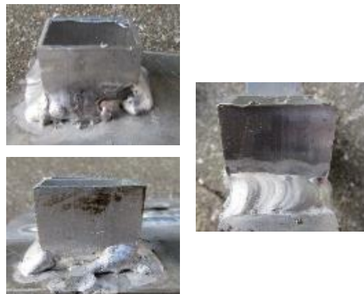
図4. 実際行った溶接 (左：失敗例、右：成功例)
