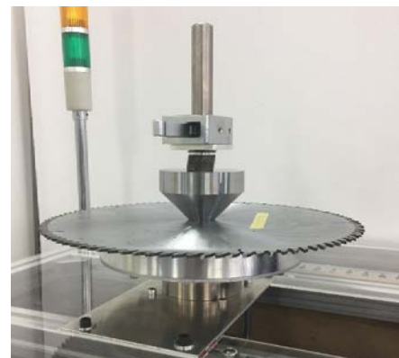
図9 実際の鋸刃回転ユニット
