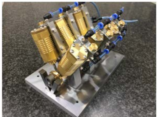
図 7 完成した V 型 6 気筒エンジン
