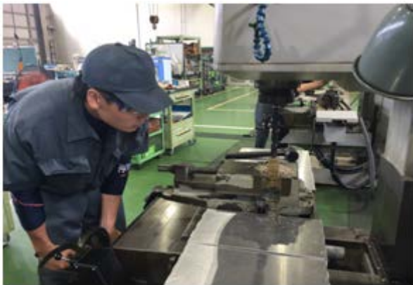
図 5 フライス盤加工の様子
