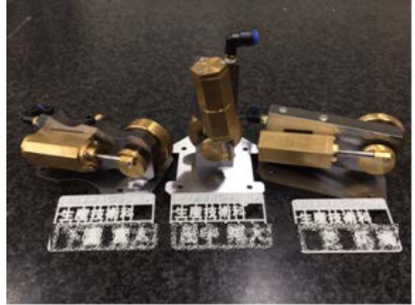
図 6 完成した単気筒エンジン
