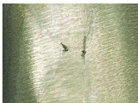
図 3：K 型での溶接時の融合不良
