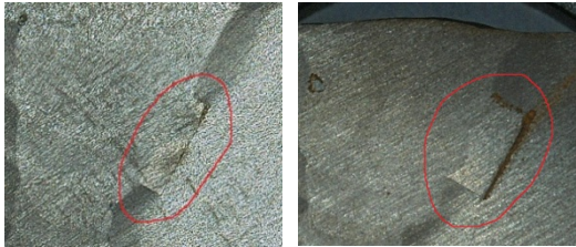
図 2：長穴深さ (左)1.6mm と(右)3.2mm
