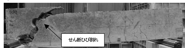
③ 重ね継ぎ手不足 (最大荷重: 29.2kN)
