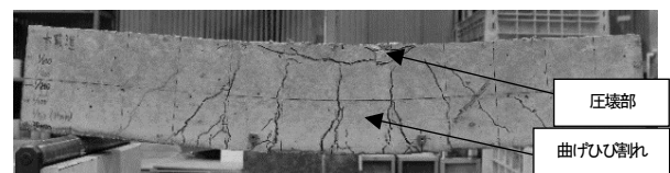
② 配管孔穴あきタイプ (最大荷重: 54.6kN)
