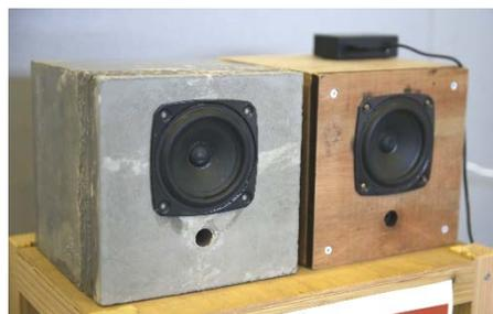
写真2 UFC 製 (左) と木製 (右) のスピーカー
