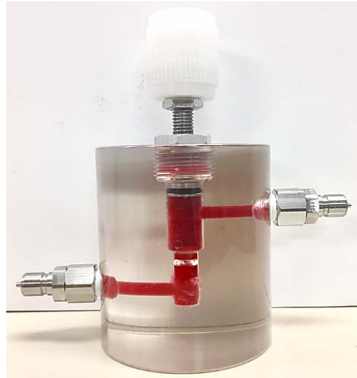
図 3 製作したリリーフバルブ
