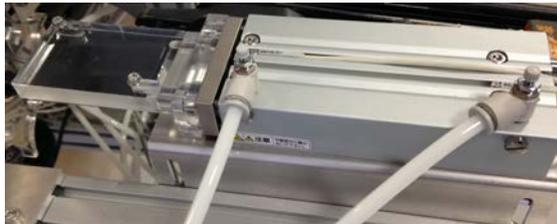
図6 打ち損じ検出機構
