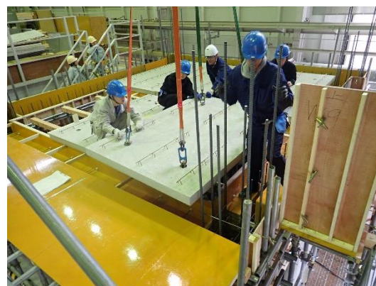
図 3-5-4 スラブ型枠のハーフ PCa 板
