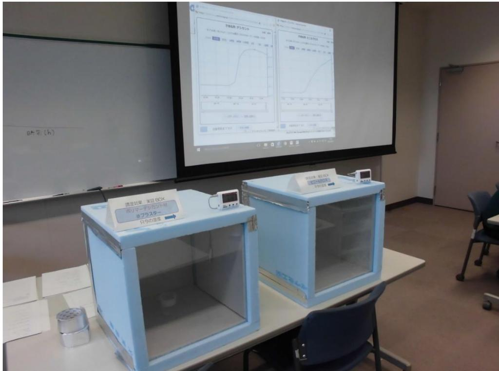
写真 4-6 補助教材(調湿 BOX)を使用した簡易実験の様子
