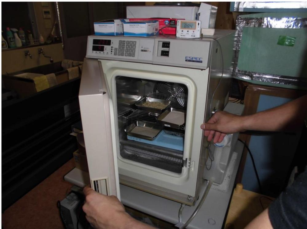
写真 4-7 調湿建材の吸放湿量試験の様子
