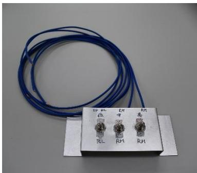
インバータの高・中・低速指令スイッチによる速度指令を行うためのスイッチである。現実には有接点リレーを使用することが多いが、今回の実習では、トグルスイッチを使用して簡易的に速度制御をすることとした。
