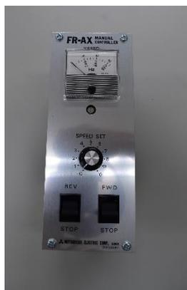
市販品の三菱電機製インバータ用のコントロールボックスである。正転・逆転および可変抵抗による速度指令ができるものであるが、高・中・低速指令スイッチによる速度指令はできないので、別途、高・中・低速指令スイッチ部により実習を行うこととした。
