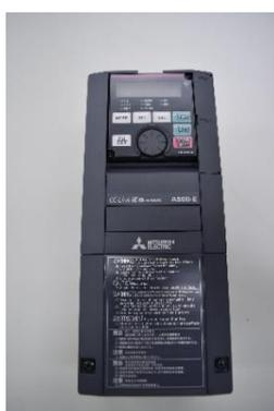
市販品のインバータである。三菱電機製のシリーズの中では最も高性能のタイプであり、センサレスベクトル制御、オートチューニング機能、イーサネット通信等の各種の機能を備えている。容量が 0.4kW と小さいので、高性能なものであっても購入コストを抑えることが可能である。
