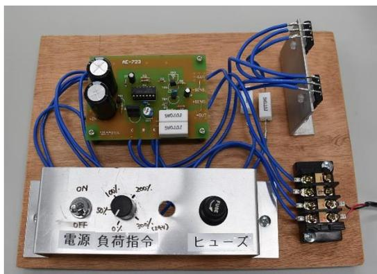
市販のシリアズレギュレータキット（秋月電子通商製の定電圧安定化電源キット実験室用精密級）を使用して、写真のような電源装置を構成した。負荷指令と表示のある可変抵抗は電圧指令用のものであり、出力電圧が可変できる。パウダブレーキは電圧—電流特性が概ね線形であるので、電流指令としても使用できる。パウダブレーキは電源投入時に突入電流が流れるおそれがあり、また、訓練中に受講生が定格を大きく超過したブレーキトルクを発生できないようにするため、基板上の半固定抵抗を操作することで電流を制限できるようにしている（ただし、キットのままではうまく電流制御ができなかったため、エミッタフォロアを追加し、一部改造している）。
