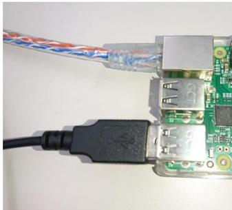
DHCP の環境下では接続するだけで IP アドレスが振られるので確認する。
