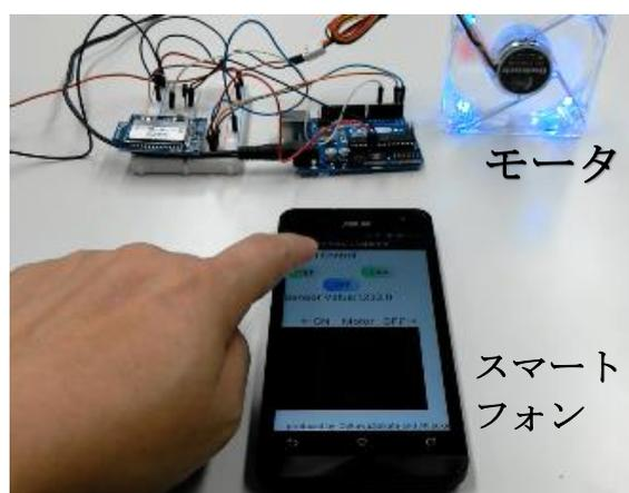
図 5.1.2 スマートフォンによるモータの無線制御
