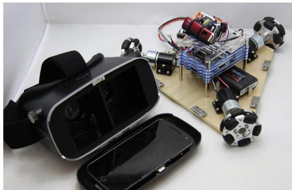
図 5. 4. 6 AR 技術を適用した全方向移動ロボット[1 スプリント目]
