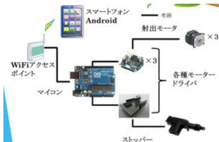
図 5.3.3 制御対象機器[スマートフォンピッチングマシン]構成
