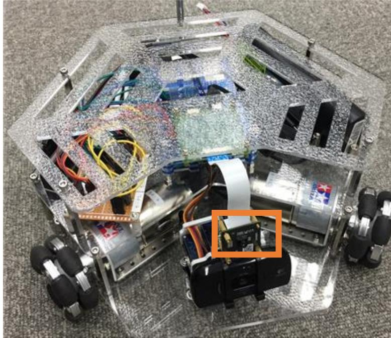
図 5.4.12 画像センサ(図の四角部分)を取り付けた AR 技術を適用した全方向移動ロボット[3 スプリント目]
