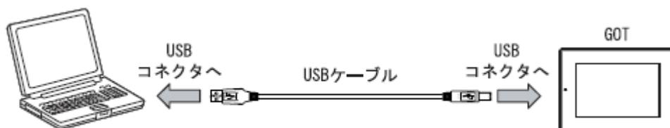
USB ケーブルを使用する場合、GT09-C30USB-5P (長さ:3m) を使用してください。
