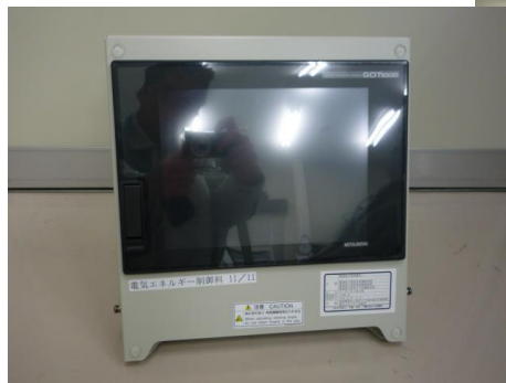
タッチパネル 本体 : GT1675M-STBA バス接続ユニット : GT15-QBUSS
