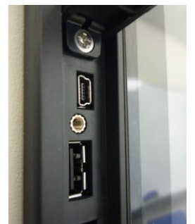
USB インターフェース (パソコンと接続) (前面)
