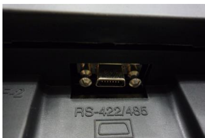
RS422/485C インターフェース (パソコンと接続) (背面)
