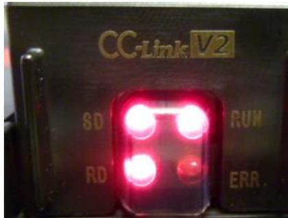
CC-Link 通信ユニットの状態または通信状態を表示します。LED 点灯状態は、通常モード、エラーモードの2種類の表示形式となっています。
