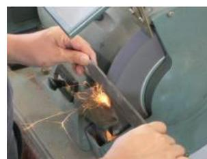
図9 裏面のグラインダ加工
